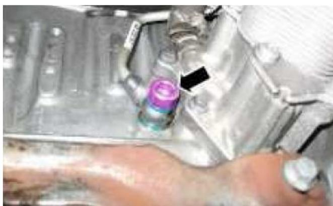
12. Sostituzione die raccordi della tubazione di alimentazione olio del turbocompressore
